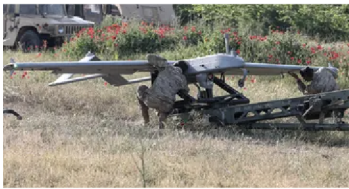
Aeronave no tripulada táctica sobre su lanzador
